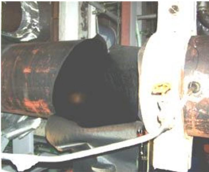
関西電力美浜発電所3号機復水配管オリフィス下流部からの蒸気噴出 2004年
