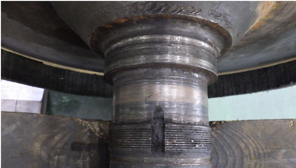
シャフトのベアリング部摩耗例
